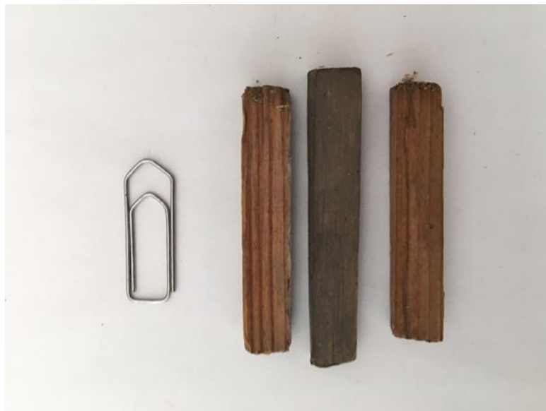
Aufstellhölzchen für die Biberschwanzziegel zur Tabakbelüftung
